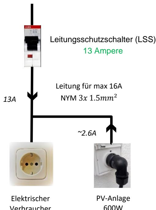
Wenn der LSS 16A gegen einen LSS 13A ausgetauscht wird, ist sichergestellt das keine Leitungsüberlastung stattfindet.
