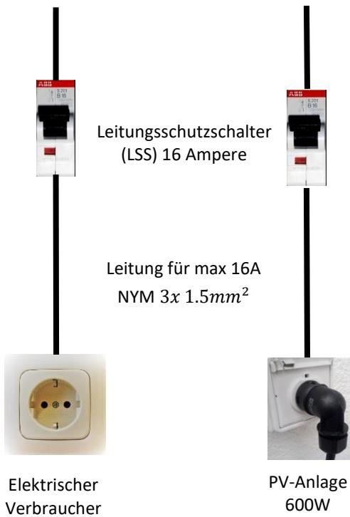
Die beste Variante ist, wenn man einen separaten Stromkreis und einen zusätzlichen LSS für die PV-Anlage vorsieht. Der Vorteil bei dieser Variante liegt darin, dass die PV-Anlage einzeln abgeschaltet werden kann.
